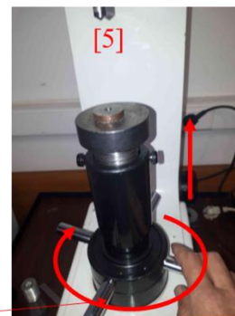
Zakretanjem matice navojnog vretena podiže se radni stol
