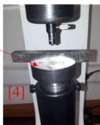
Zakretanjem matice navojnog vretena podiže se radni stol
