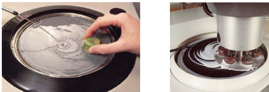
Slika 5.12 Ručno poliranje uzoraka (lijevo) i automatizirano poliranje više uzoraka (desno)
