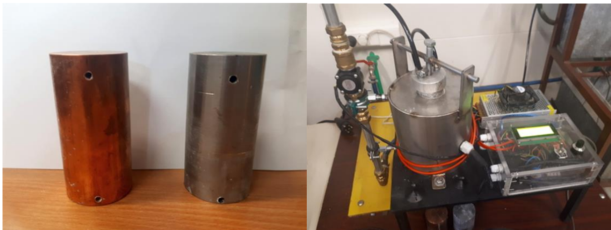
Slika 3.5 Ispitni uzorci i uređaj za ispitivanje toplinske vodljivosti metala
