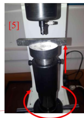
Zakretanjem matice navojnog vretena podiže se radni stol
