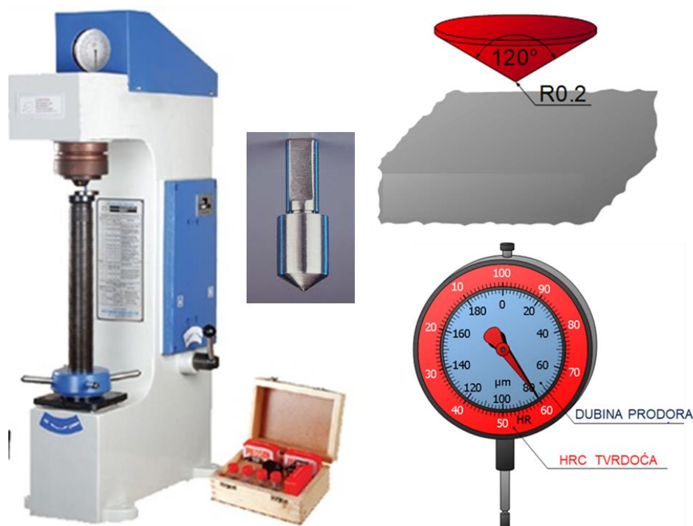
Slika 12.1 Univerzalni tvrdomjer (lijevo), geometrija penetratora (desno gore) i mjerna ura (desno dolje)
