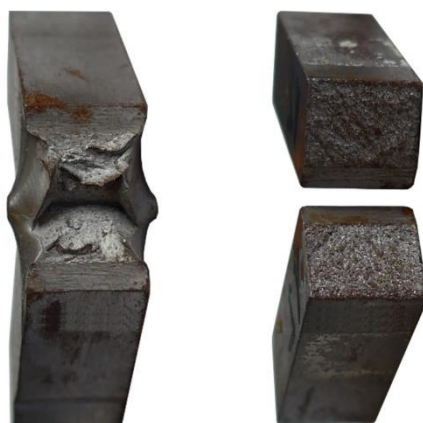
Slika 14.12 Žilava i krta Charpy epruveta nakon ispitivanja
