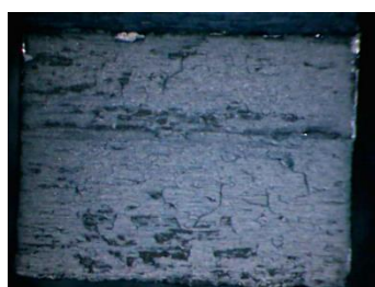
KALJEN U ULJU KV=30 J
